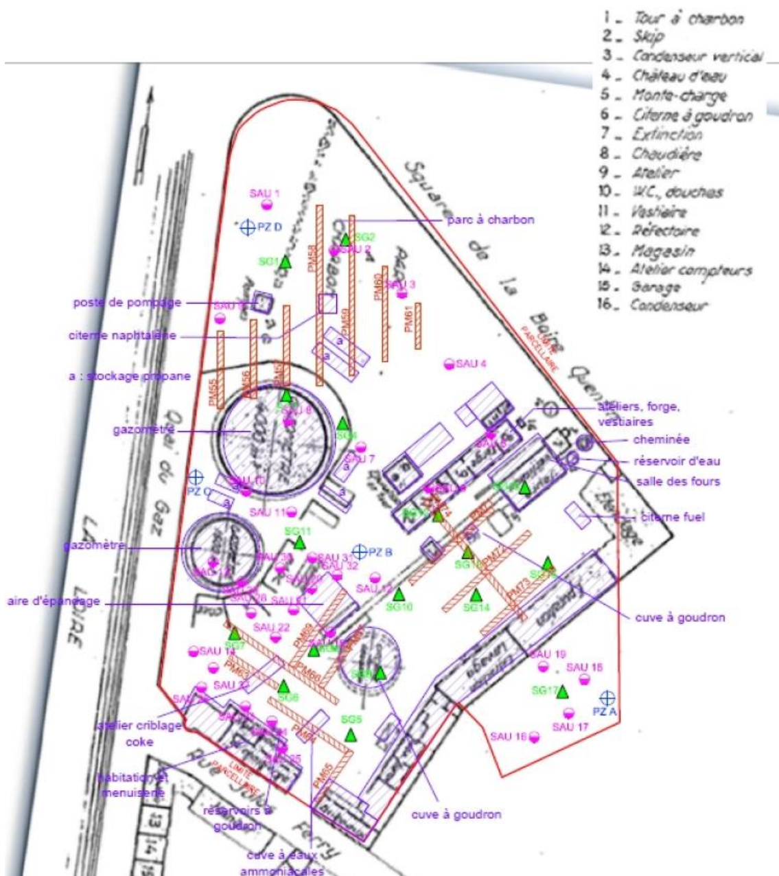
Figure 1 : anciennes installations (violet) et principales investigations réalisées en 2013 (tranchées et sondages (Pm, SG, SAU))
