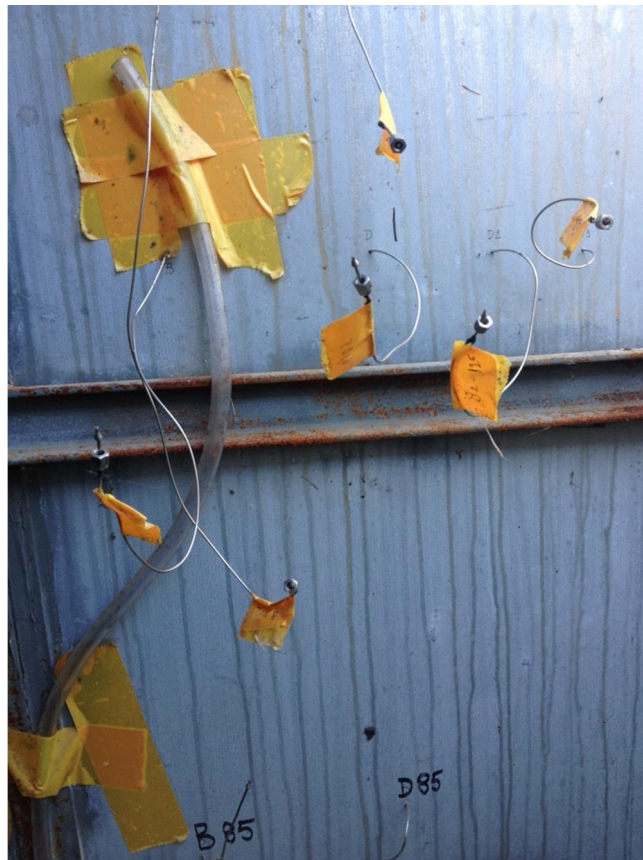
Figure 21: Sondes à gaz
