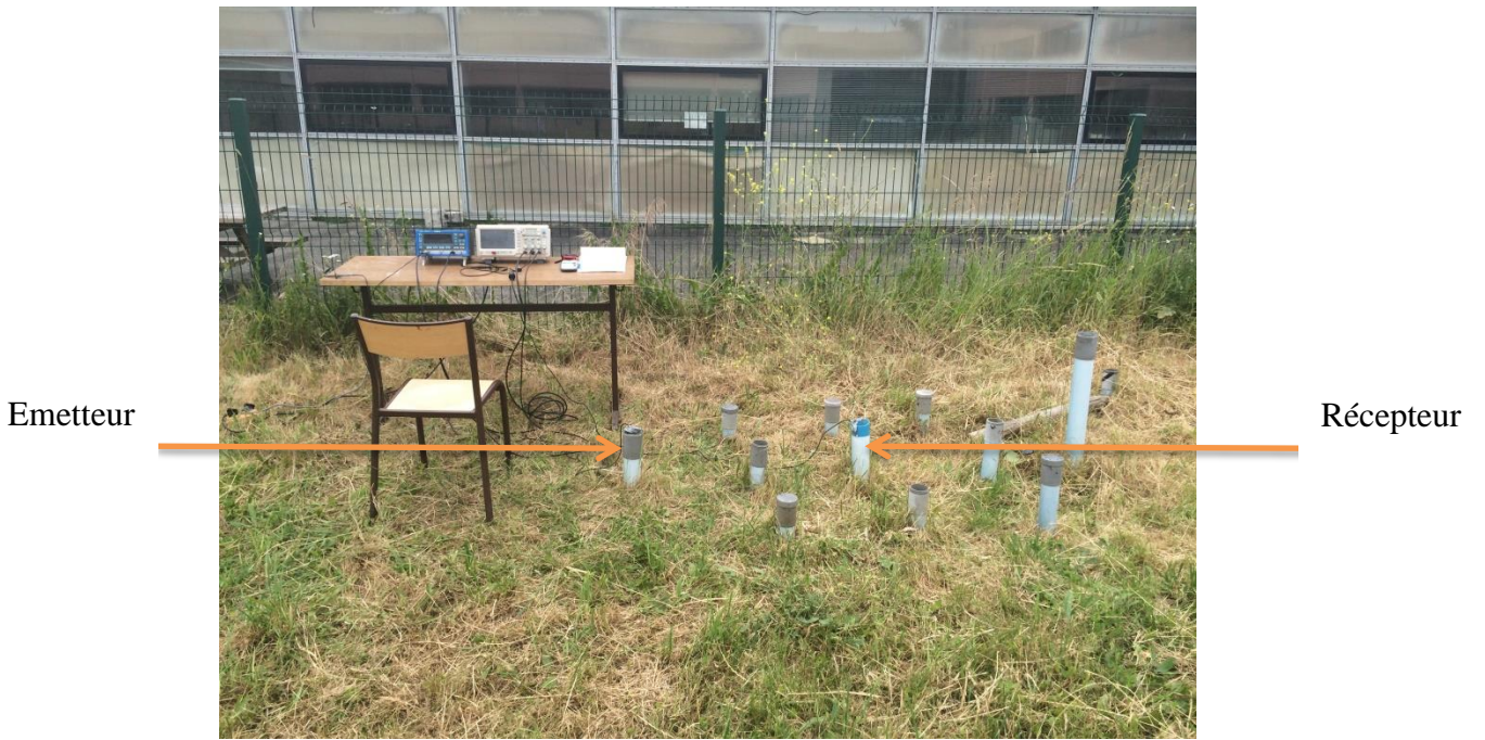
Figure 25 : montage émetteur-récepteur dans le champ
