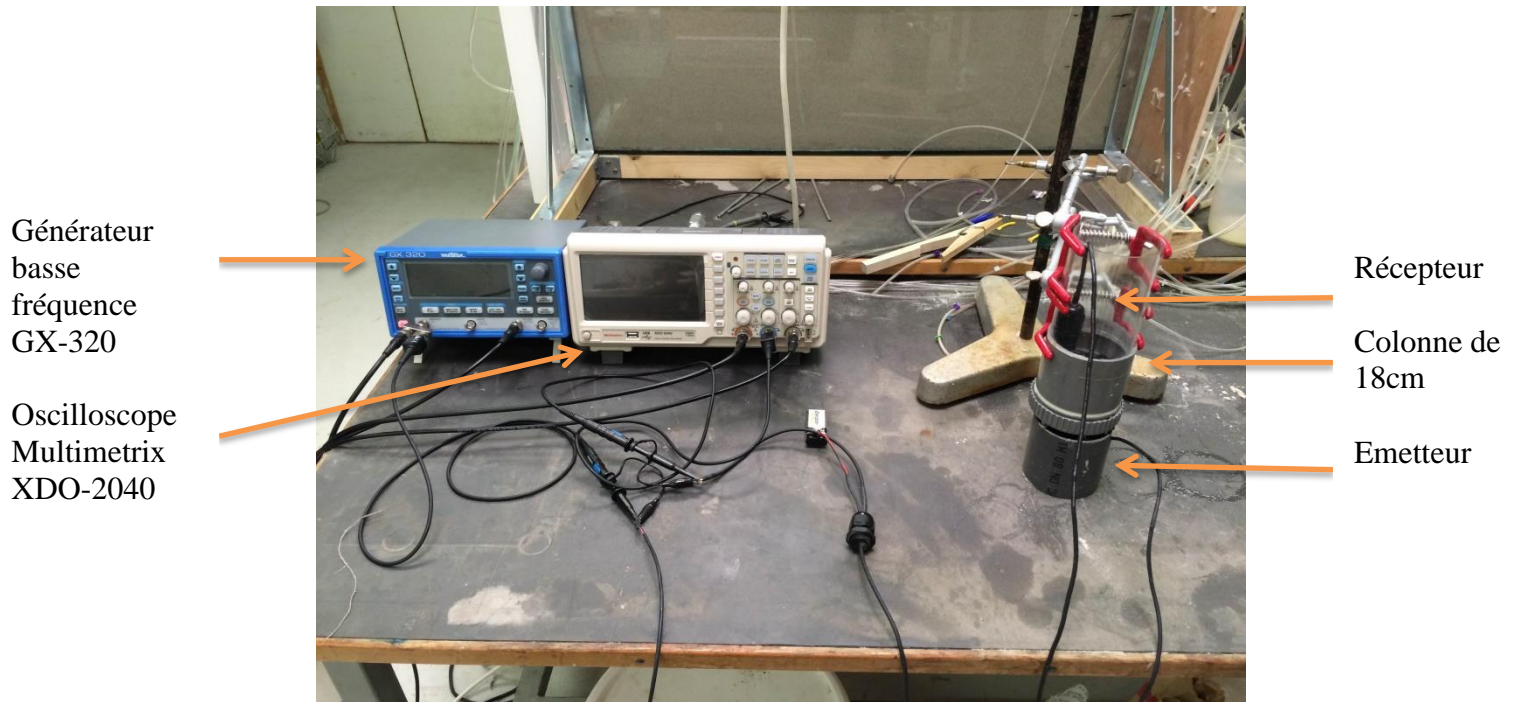
Figure 5 : photo du montage sur colonne
