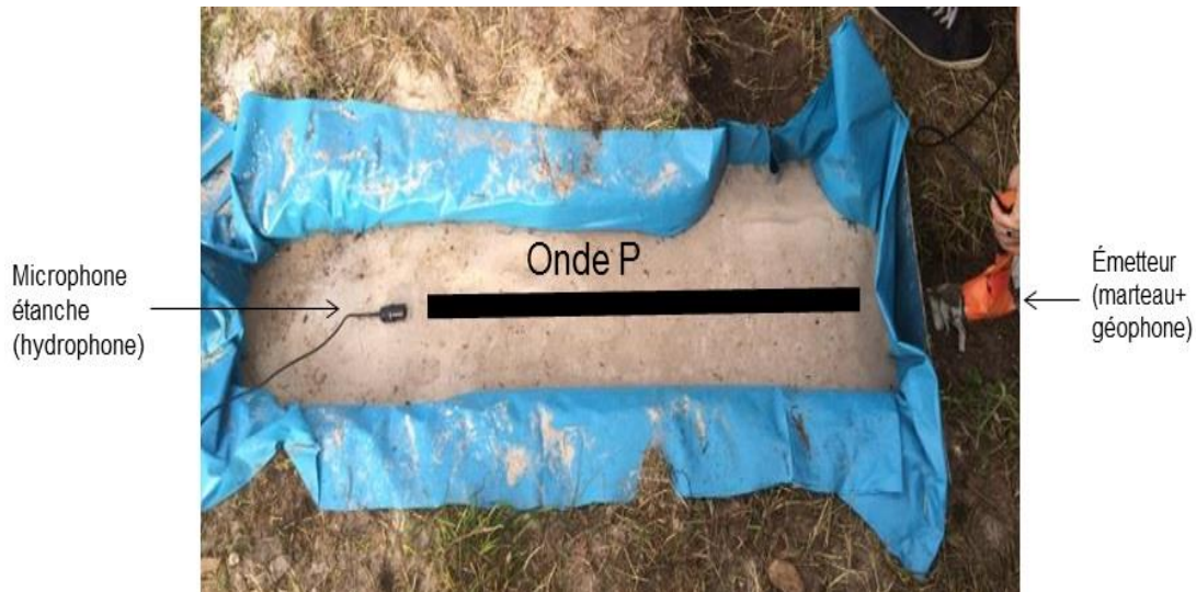
Figure 7 : Méthode de production des ondes P
